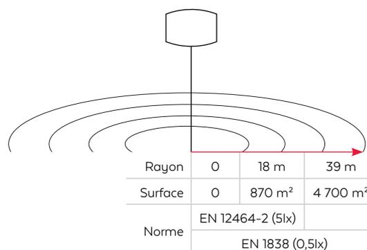
Comprendre le schéma : dans un rayon d'action de 39 m, soit une surface de 4 700 m<sup>2</sup>, nous garantissons un éclairage conforme à la norme EN1838.
